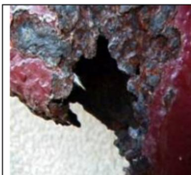
Fig. 7 Componente hueco con corrosión desde el interior, no protegido.
