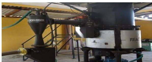
**Figura 2. Gasificador downdraft con sistema de limpieza húmeda (ciclón, scrubber)**
