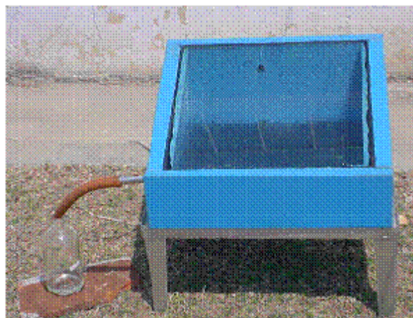
Foto 1. El destilador solar de fibra de vidrio.
