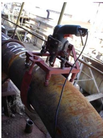
**Fig. 1** Dispositivo para el desbaste y pulido *in situ*.
