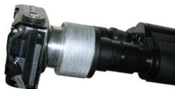
**Fig. 3** Dispositivo para la toma de imágenes metalográficas.
