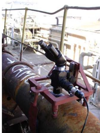
**Fig. 2** Dispositivo para la observación metalográfica.
