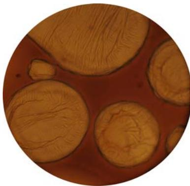
**Fig. 7** Microfotografía de una emulsión con emulgente P, con agua tratada magnéticamente a 1,5 m/s.
