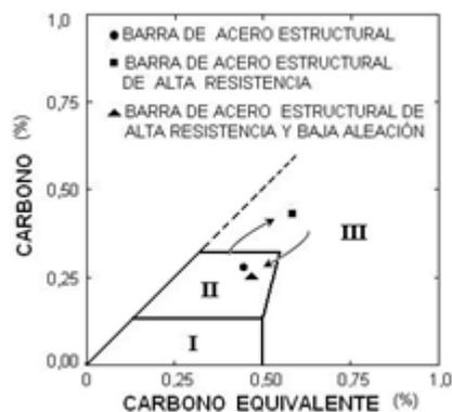
**Fig. 1 Niveles de soldabilidad de las barras de acero estructural.**
