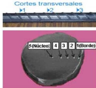
Puntos de medición de HV en un corte
