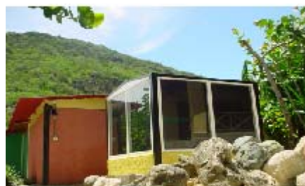
Fig. 1: Fotos de un secador solar de semillas y granos con cubierta de polietileno de 3 m 2 y del "Saunasol", sauna solar cubana. Ambos son novedosos y la sauna ha sido aplicada en el sector turístico y con fines médicos.
