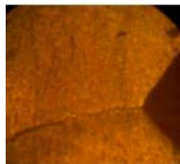
**Fig. 2 Imagen de probeta preagrietada del material nuevo a temperatura ambiente.**
