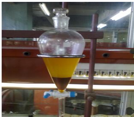
Fig. 2 Separación de las fases de ésteres etílicos y glicerina
