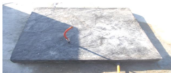
Fig.1 Foto del calentador “FIMSOL 3”, hecho con materiales de la construcción
