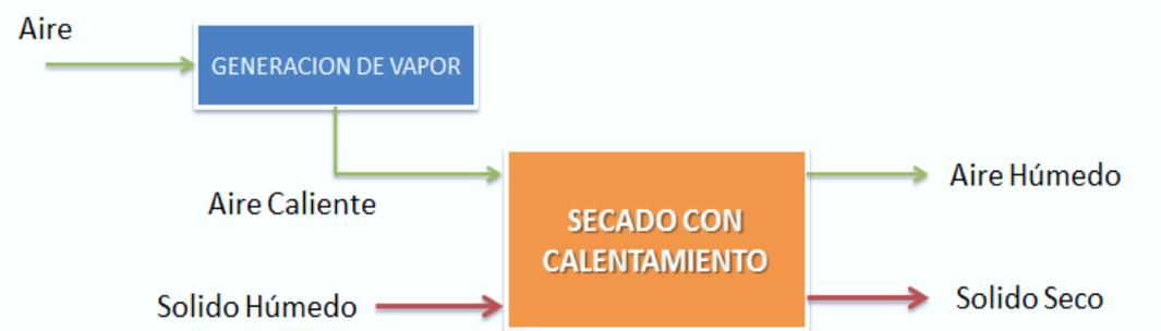
**Fig.1 Diagrama de flujo para el funcionamiento del secador de bandeja Edibon, Modelo SBAN.**
