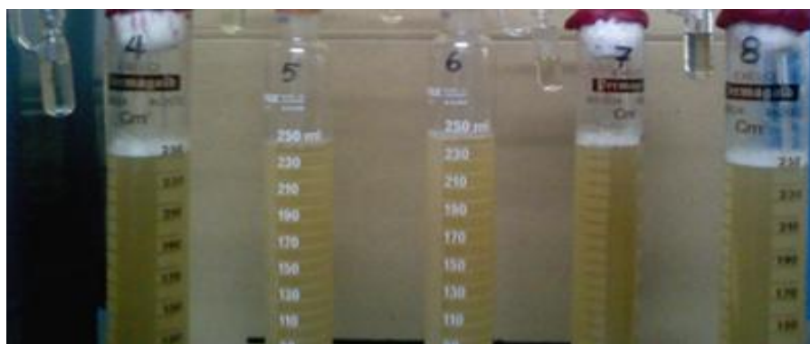
Fig. 2 Producción de alcohol por fermentación de 250 mL de mosto de azúcar crudo de 17 °Bx con la cepa S. cerevisiae uvaferm a los 10 días.
