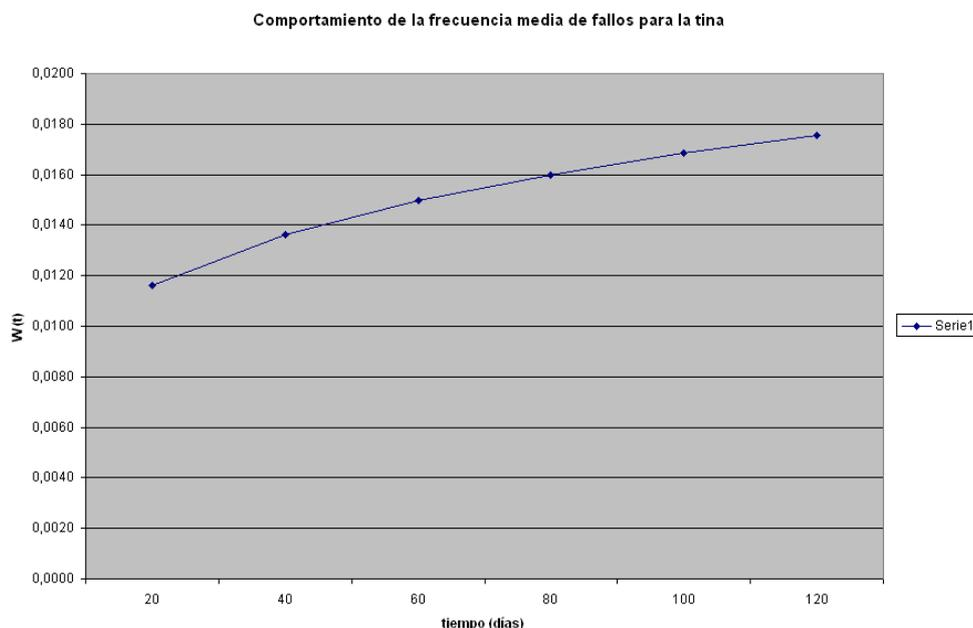
**Fig. 1 Comportamiento de la frecuencia media de fallos  $W(t)$  (1/d) para el mezclador-sedimentador, (tina) en el proceso de elaboración del mosto.**
