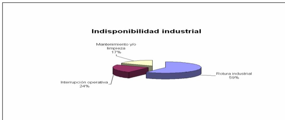
**Fig. 3 Distribución de la indisponibilidad industrial en el proceso de elaboración del mosto cervecero (proceso en caliente).**
