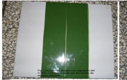
**Fig. 3 Azulejo de prueba de pigmento obtenido a partir del dicromato**
