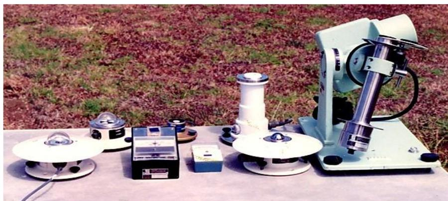
**Fig. 2 Instrumentos para medir la Radiación solar-Global, Directa y Ultra Violeta.**
