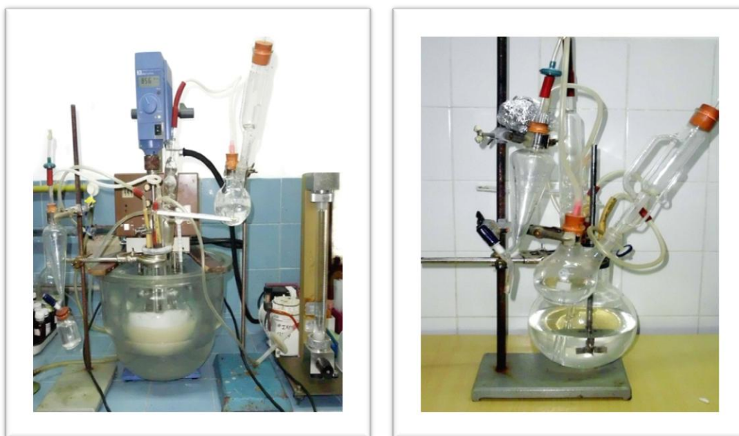
Figura 2. Fotografía del biorreactor y sus dispositivos auxiliares. Izquierda: Biorreactor en funcionamiento. Derecha: Biorreactor preparado para la esterilización en autoclave
