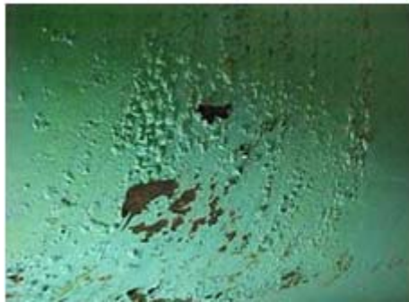
Fig. 3 Aspecto exterior de tuberías afectadas por la corrosión.
