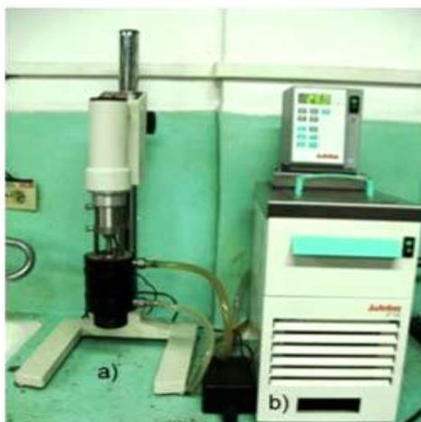
Figura 2. a) Reómetro ThermoHaake 550, b) Calefactor
