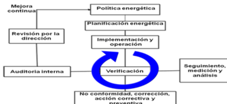
Fig. 1 Modelo del SGen según la NC-ISO 50001: 2011.
