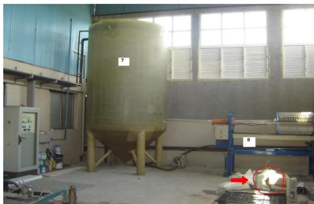
**Figura 3. Sedimentador y filtro prensa**
