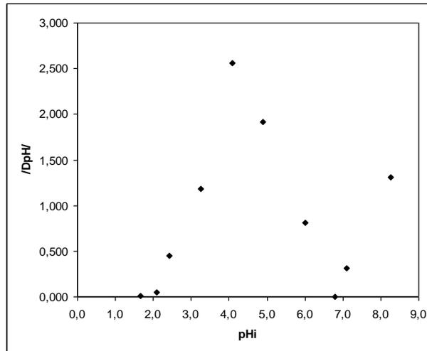
Figura 4. Punto de carga cero ( $\text{pH}_{\text{pzc}}$ ) del biosorbente algal con tamaño de partículas de 0,5-1,0 mm
