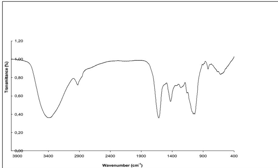
Figura 2. Espectro FTIR del biosorbente algal con tamaño de partículas de 0,5-1,0 mm
