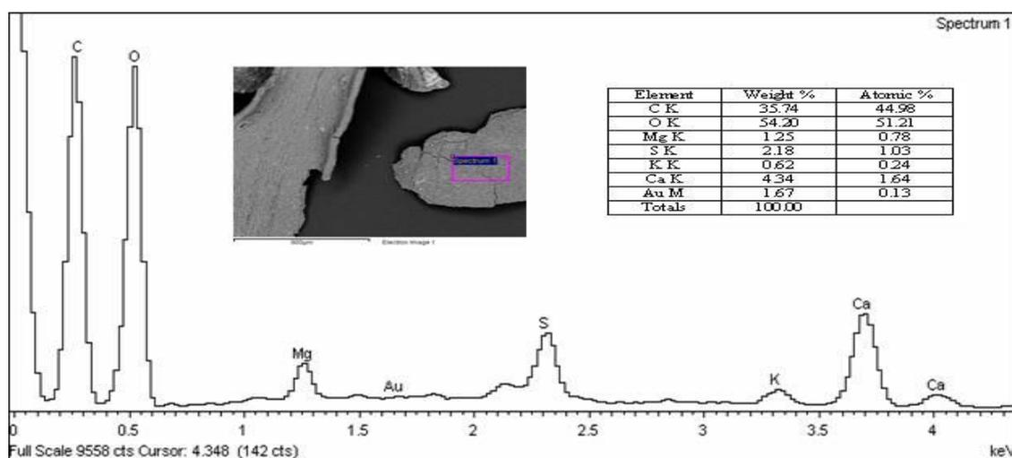
Figura 1. Espectro SEM/EDX del biosorbente algal con tamaño de partículas de 0,5-1,0 mm
