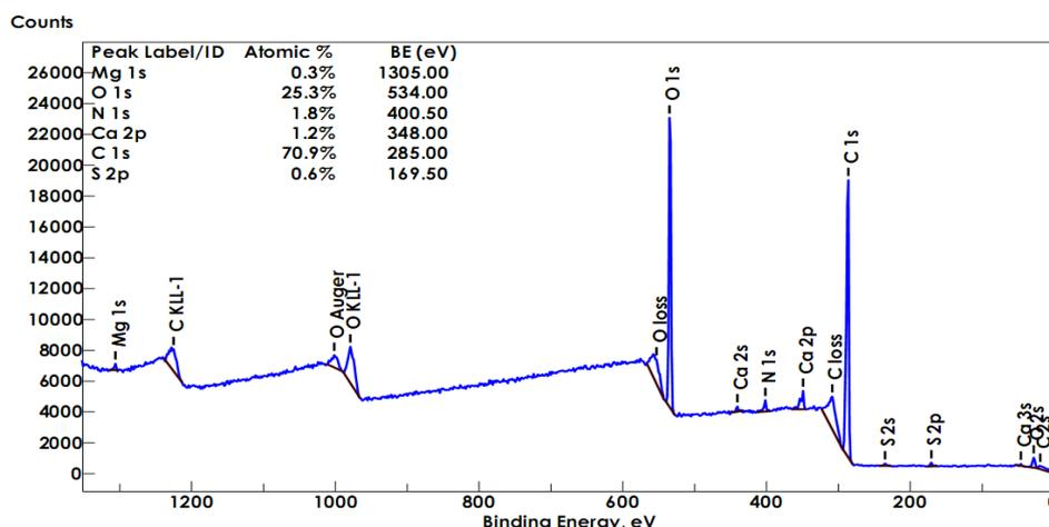
Figura 3. Espectro XPS del biosorbente algal con tamaño de Partículas de 0,5-1,0 mm
