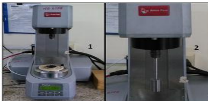
Fig. 4 Reómetro Anton Paar Physica MCR 301 utilizado en la experimentación (1- Vista general, 2- Vista del sensor).
