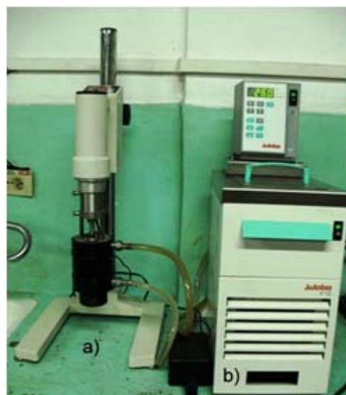
**Fig. 2 Equipos de ensayo: a) Reómetro ThermoHaake 550, b) Calefactor.**
