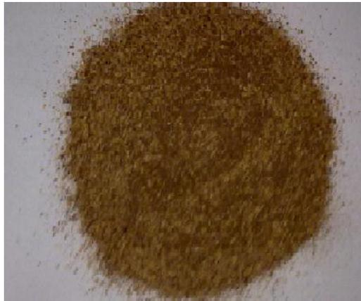
**Fig. 3 Arcilla y aserrín luego de ser mezclados en seco.**
