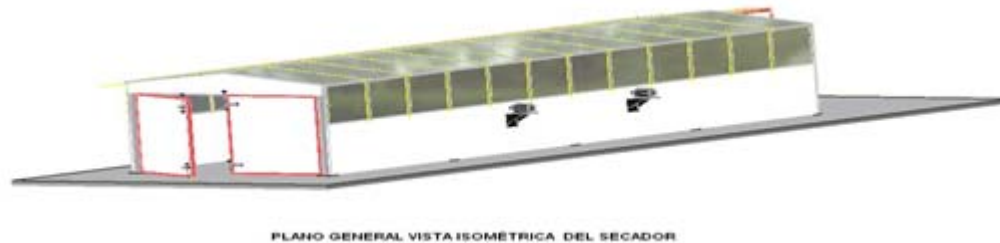
Fig. 1 Secador solar multipropósito con paneles metálicos aislantes autoportables.
