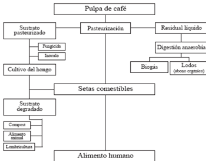
Fig. 1 Esquema que muestra el aprovechamiento integral de los subproductos de la agroindustria del café en Cuba para la producción de setas comestibles ( Pleurotus ), incluyendo el aprovechamiento de los subproductos derivados de su aplicación.
