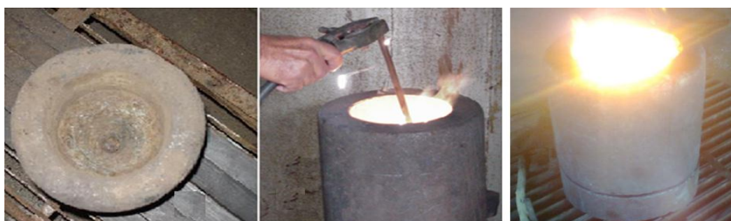
Fig. 1 Reactor de grafito utilizado para el procesamiento aluminotérmico.
