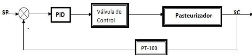
Figura 8. Diagrama de bloques del lazo de control.
