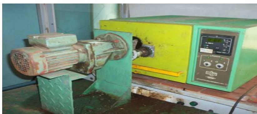
Figura 1. Imagen del horno mufla utilizado.
