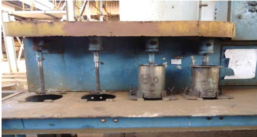
**Figura 2. Banco de reactores utilizados para lixiviar.**
