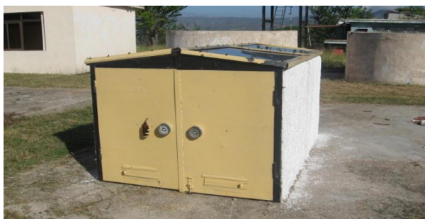
Fig.3- Prototipo de secador solar para anamú
