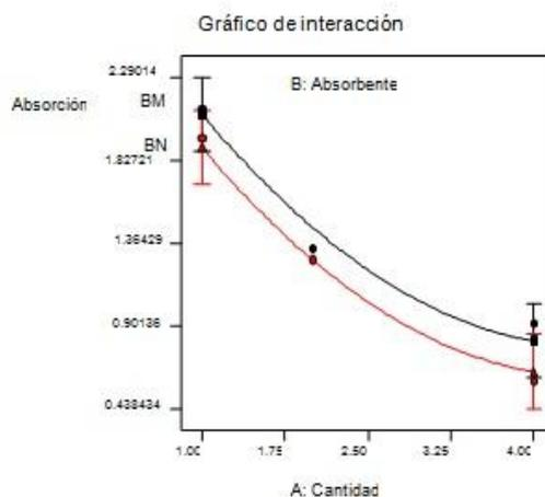
**Fig.2- Modelo gráfico de la adsorción del crudo tipo P (g HC/g absorbente).**
