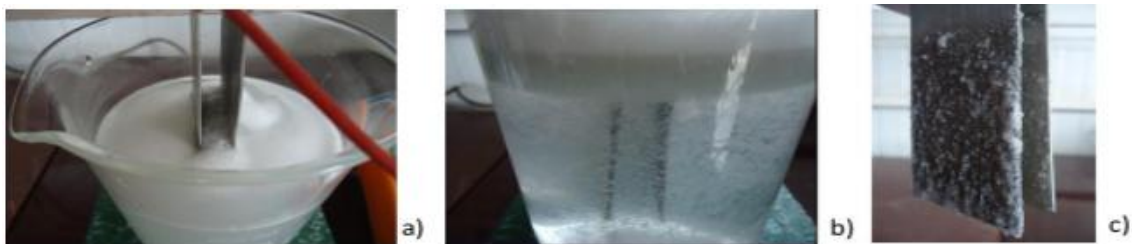
Fig. 8. Proceso de electrocoagulación. a) Espuma blanca en la superficie y entre los electrodos. b) Flóculos suspendidos. c) Espuma y flóculos incrustados en las placas
