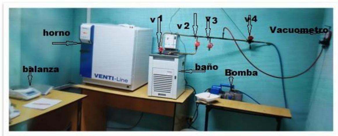
**Fig.1- Instalación experimental para evaluar los pares adsorbentes/refrigerantes**
