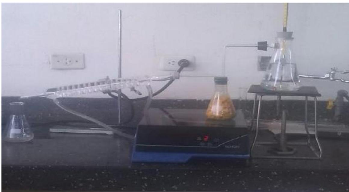
**Fig. 2** - Montaje experimental por arrastre de vapor
