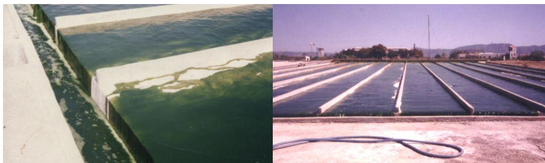
Fig.1- Fotobiorreactor de capa fina de 500 m 2 . Centro de Investigaciones de Energía Solar. Santiago de Cuba
