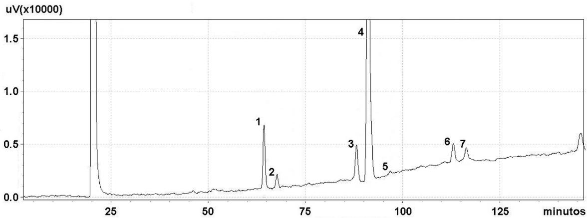
**Fig. 2-**Diagrama característico de la cromatografía de gases para las muestras de aceite. **1** – Ácido palmítico, **2** – Ácido palmitoleico, **3** – Ácido esteárico, **4** – Ácido oleico, **5** – Ácido linoleico, **6** – Ácido araquidónico y **7** – Ácido behénico.
