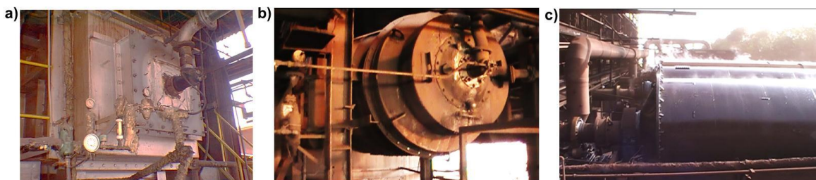
Fig. 1- Instalación, a) Quemador horno de planta piloto b) Quemador - cámara de combustión horno industrial c) Enfriador rotatorio industrial
