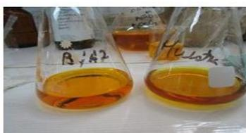
**Fig. 5-** Solución de dicromato de potasio, a) preparada con el blanco y b) con adición de - ácido sulfúrico concentrado
