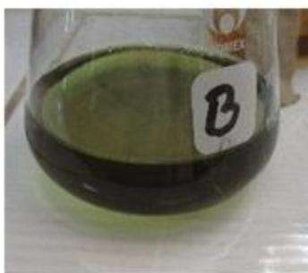
**Fig. 4.** Punto final de la titulación del tiosulfato de sodio para 0.1 N con almidón ( $C_6H_{10}O_5$ )<sub>n</sub> como indicador.
