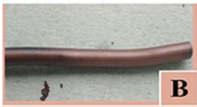
Fig. 3- Varilla sin óxido después de la prueba
