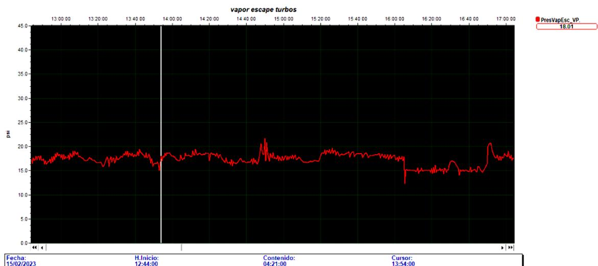
**Fig.3- Presión del vapor de escape**
