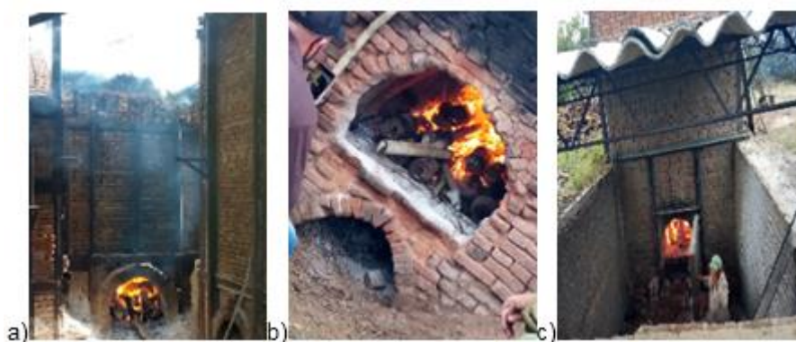
Fig. 2- Apariencia de la combustión al adicionar corte OBM a los hornos: a) tejar Guanabo, b) tejar Manicaragua, c) tejar Encrucijada.
