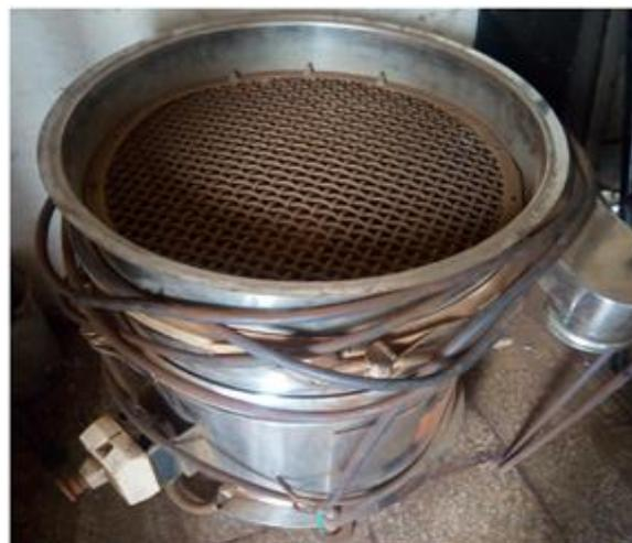
**Fig. 1-** Tamizadoras para la caracterización granulométrica
