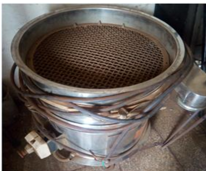
Fig. 1- Tamizadoras para la caracterización granulométrica
