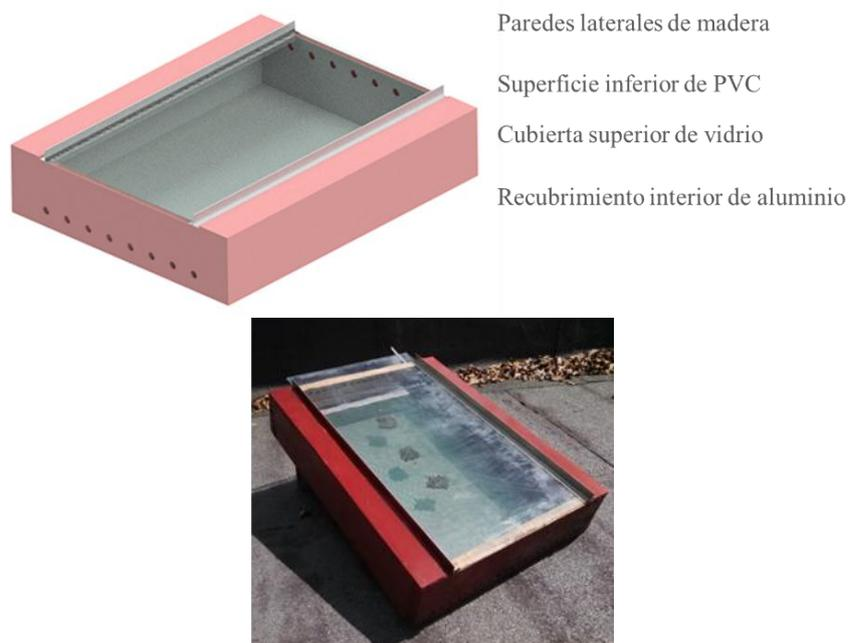
**Fig.2-** Secador solar de convección natural directa.
