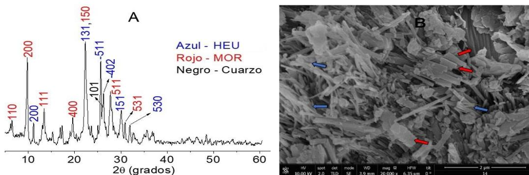
**Fig. 1-** A) Patrón de DRX del material Znat, picos de difracción (*hkl*) característicos para las fases zeolíticas tipo HEU (color azul) y MOR (color rojo). B) Micrografía de SEM de Znat; las flechas rojas indican los cristales de MOR y las azules los de HEU
