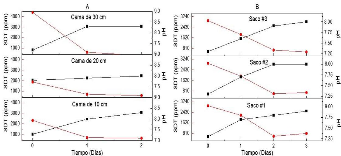
**Fig. 3-** Valores de pH (en negro) y SDT (en rojo) en el tiempo para los materiales al ser expuestos en agua para ambas alternativas de curado: A) camas con diferentes espesores y B) envasados en sacos (#1, #2 y #3)
