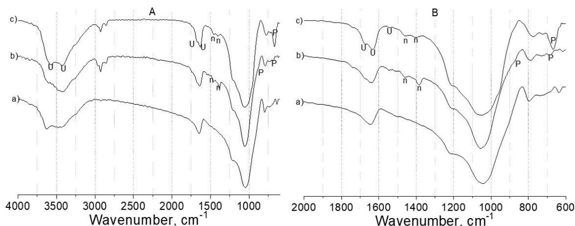
**Fig. 2-** Espectros FTIR de Znat (a), NEREA<sup>®</sup> Sustrato (b) y NEREA<sup>®</sup> Plus (c) en las regiones de 4 000 – 600 cm<sup>-1</sup> (A) y de 2 000 – 600 cm<sup>-1</sup> (B, ampliación). Las letras n, P y U indican las bandas asociadas a especies de nitrógeno, fósforo y urea, respectivamente
