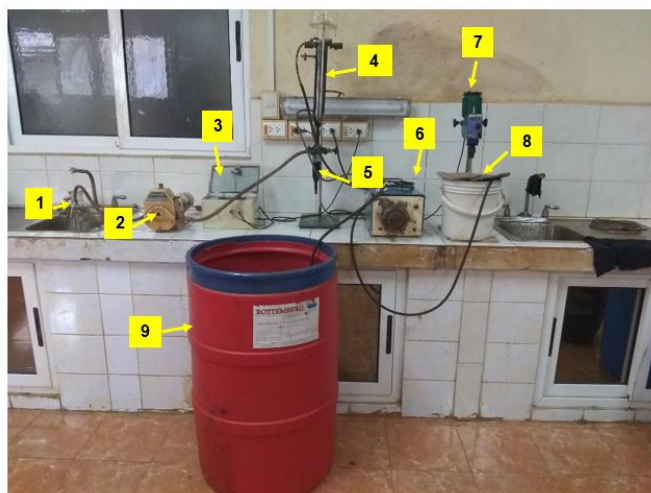
Fig. 1- Instalación experimental, clasificación del sólido residual: 1- Depósito de agua para alimentación al elutriador, 2- Bomba para la alimentación de agua, 3- Regulador de flujo, 4-Clasificador-Elutriador, 5- Depósito de arena elutriada, 6- Bomba para la alimentación de cola, 7- Agitador, 8- Depósito de cola para la alimentación al elutriador, 9- Depósito del fino elutriado
