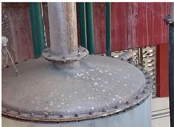
Fig. 1- Imagen de la tapa de la columna de destilación objeto de estudio. Radio: 0.63 m, material: cobre (no pulido)
