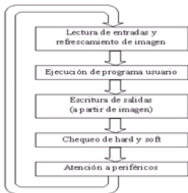
Fig. 2 Ciclo de trabajo de un PLC.
