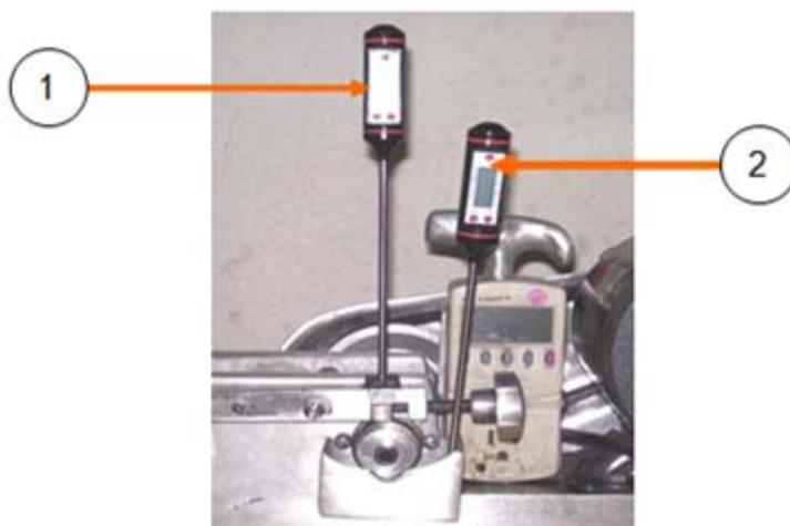
**Fig. 3 Termopares: 1 termopar en el contacto, 2 termopar en el aceite.**
