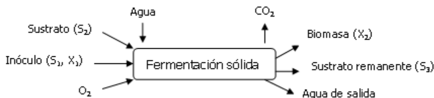
Fig. 1 Elementos de entrada y salida para el balance de masa durante la producción de setas comestibles.
